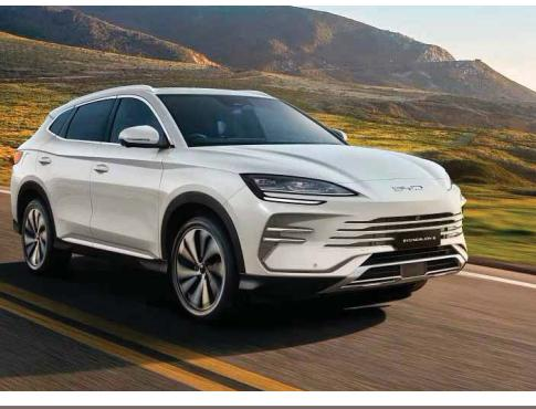
Sealion 6 เป็น SUV 5 ประตู ที่มีความยาว 4,475 มิลลิเมตร และระยะฐานล้อ 2,765 มิลลิเมตร ซึ่งถือว่าอยู่ในระดับประมาณ C-Segment ออกแบบภายใต้คอนเซ็ปต์ OCEAN X ด้านหน้ามีความโค้งมนมากพร้อมโคมไฟแบบดี C รับกับกระจังหน้าแบบคลื่นทะเลลดรูสวายางและแบลคตา เส้นสายด้านข้างตัวรถเสริมให้ดูรุ่งคุมมิติและหรูหรามากขึ้น ตกแต่งขอบชั้มล้อด้วยแถบพลาสติกสีดำตามสไตล์รถ SUV
